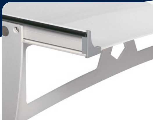
Profilo in alluminio lato muro con guarnizione integrata per la tenuta dell'acqua
