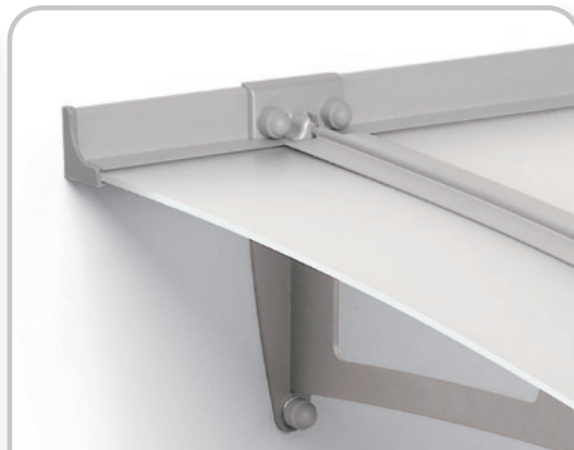
Mensola portante in acciaio inox con aggancio rapido del profilo premilastra in alluminio per la tenuta del tettino in acrilico di 4 mm
